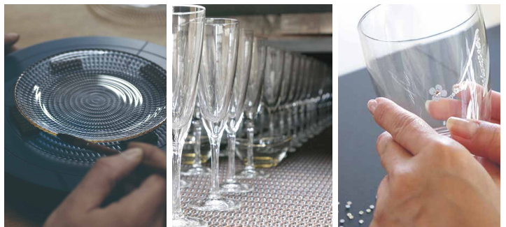
フチ巻き…職人が1点ずつフチ巻き 焼成炉…高温でインクを焼きつけ 石つけ…手作業で手早く丁寧に
