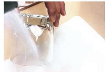
トミレーベルのために独自開発した砂糖状のガラスの粉。手作業でふりかけてから焼成すると、でこぼこしたエンボス効果に。ガラスはもちろん、陶器にも。シルクスクリーンによるダイレクト印刷と転写での絵付けの2つのプリント方法が可能。
